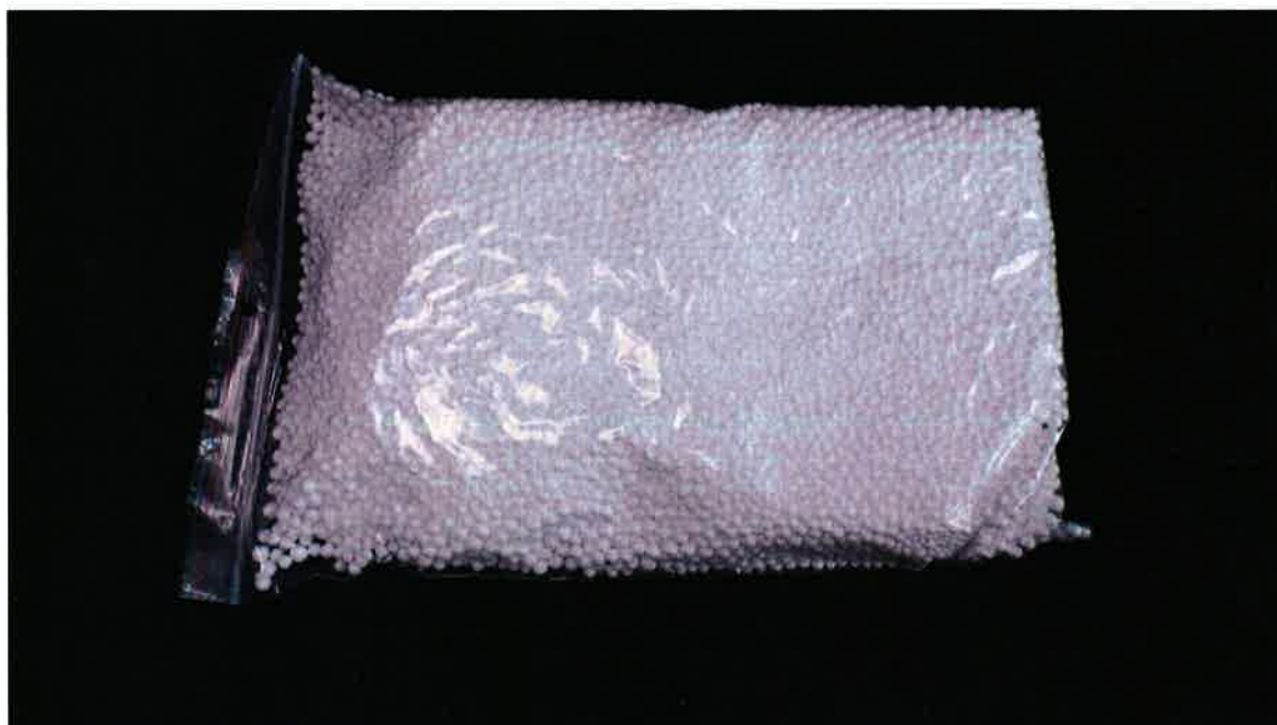
Obr. 1 Vzorek - Polystyrenové kuličky, materiál Extir AM A 5000 AE
